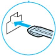
4. Après avoir terminé le nettoyage de la vitre antipoussière, poussez doucement le détergent pour vitre vers l'arrière du capot avant de la machine.
